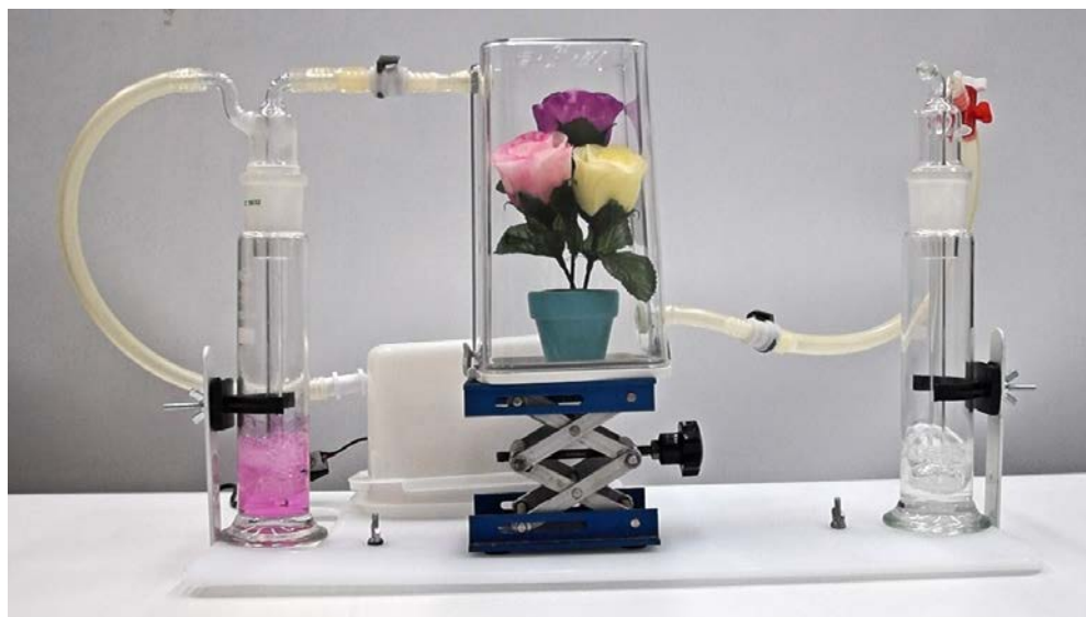
Fig. 4.- Sistema seguro para la manipulación de gases químicas
