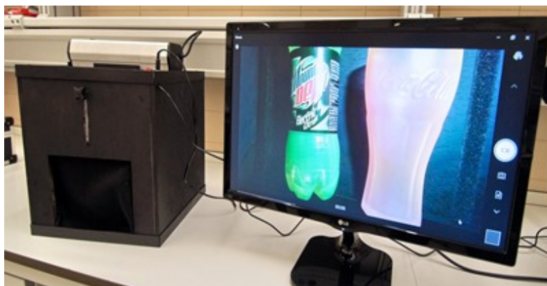
Fig. 3.- Sistema para mostrar fenómenos luminiscentes en lugares iluminados
