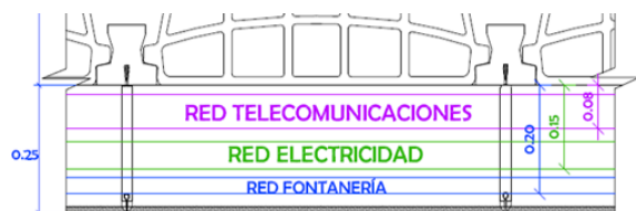
Conducciones en el falso techo
