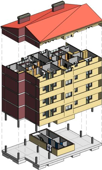
La cimentación del edificio se realiza con zapatas aisladas o combinadas de hormigón armado HA-25/B/16/IIA y acero B-500S unidas entre sí mediante vigas de arriostramiento. Los esfuerzos generados por las cargas lineales (muros de la planta baja), serán absorbidos por las vigas de arriostramiento antes mencionadas.
